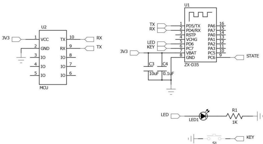
说明：做串口透传应用时可只需连接 7 (VBAT)/8 (GND)/2 (RX)/1 (TX) 脚，
